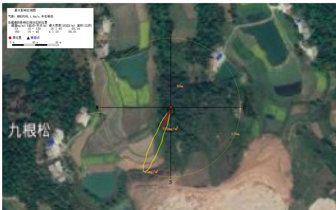
图 6-19 盐酸泄漏超过阈值的最大轮廓线软件截图
