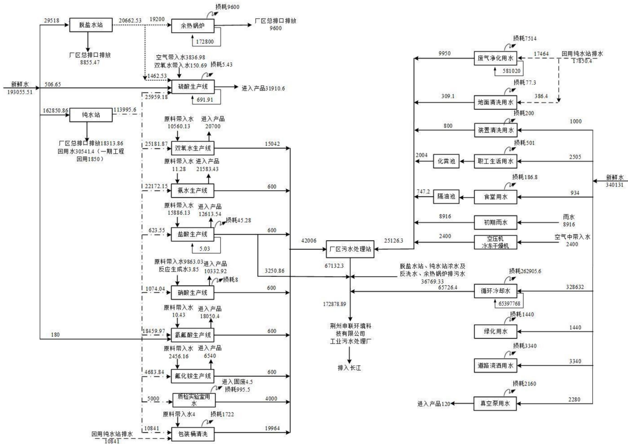
图 4.10-1 本项目水平衡分析图 (单位: m³/a)
