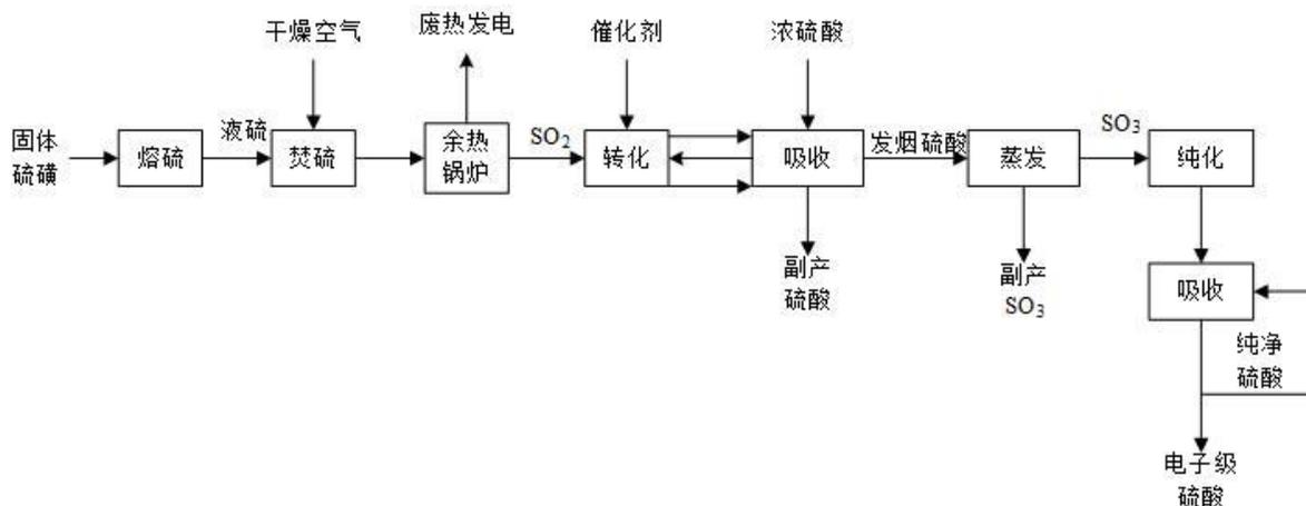
图 4.1-1 硫酸生产工艺路线图
