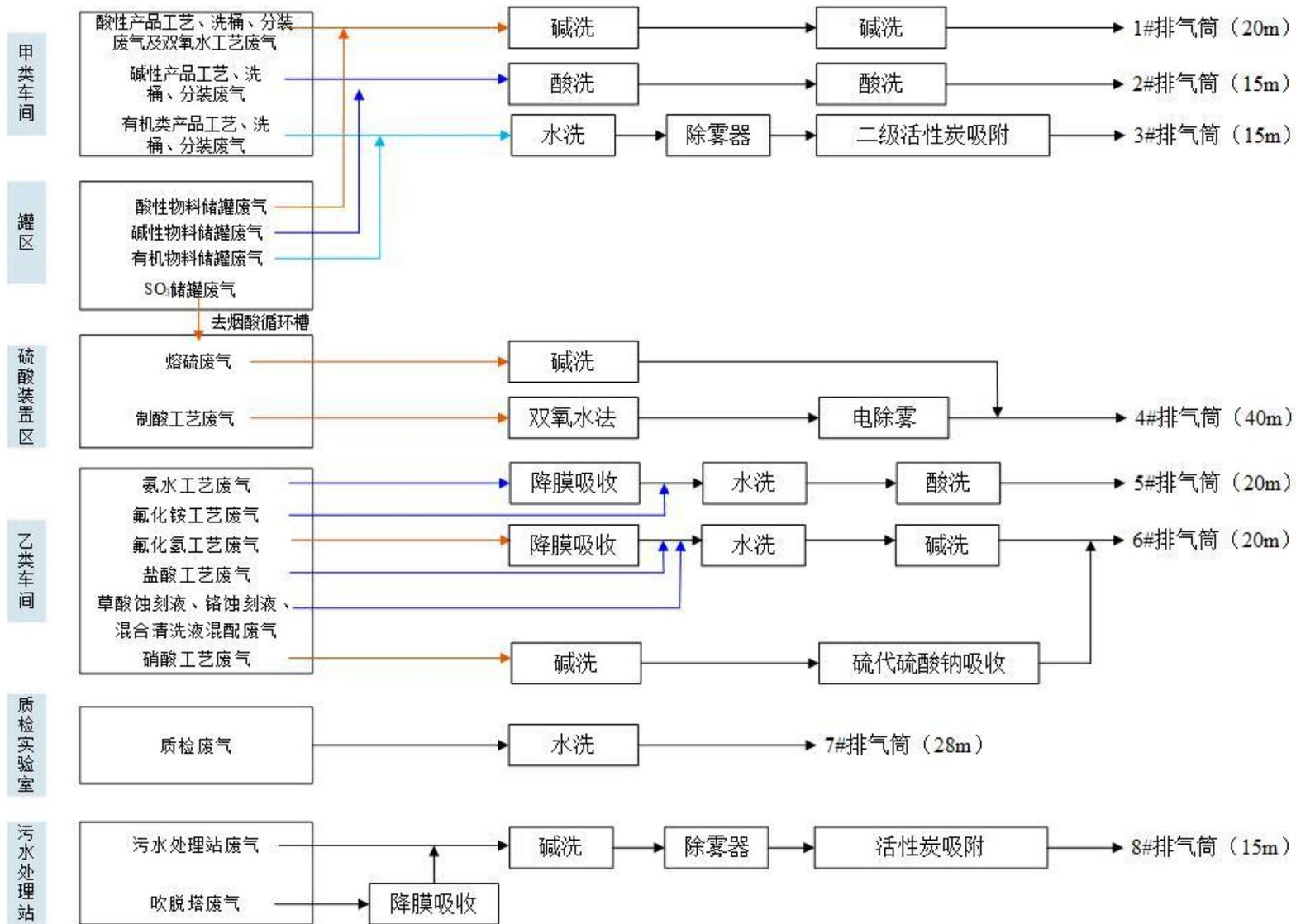
图 8.1-1 项目废气处理路线图
