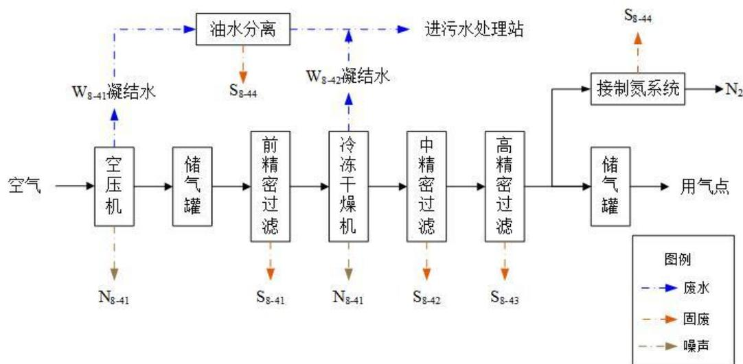
图4.8-4 空压站工艺流程及产污节点示意图
