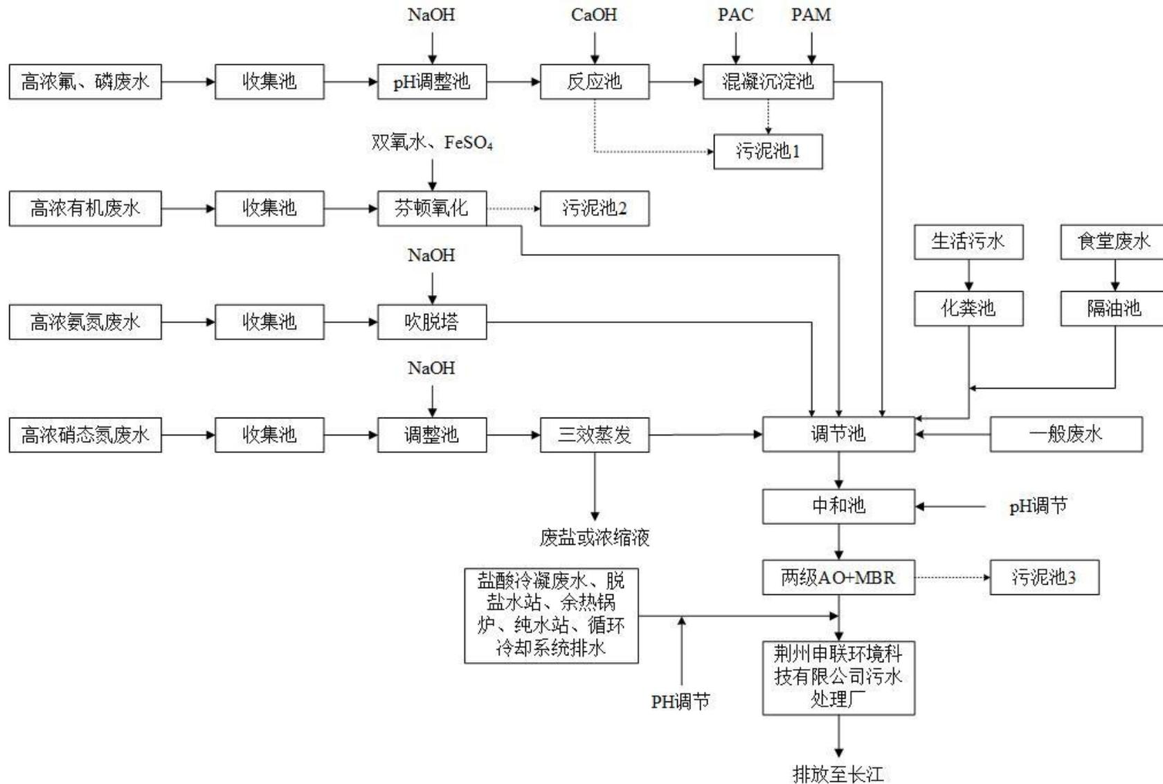
图 8.1-6 本项目废水处理工艺流程示意图
