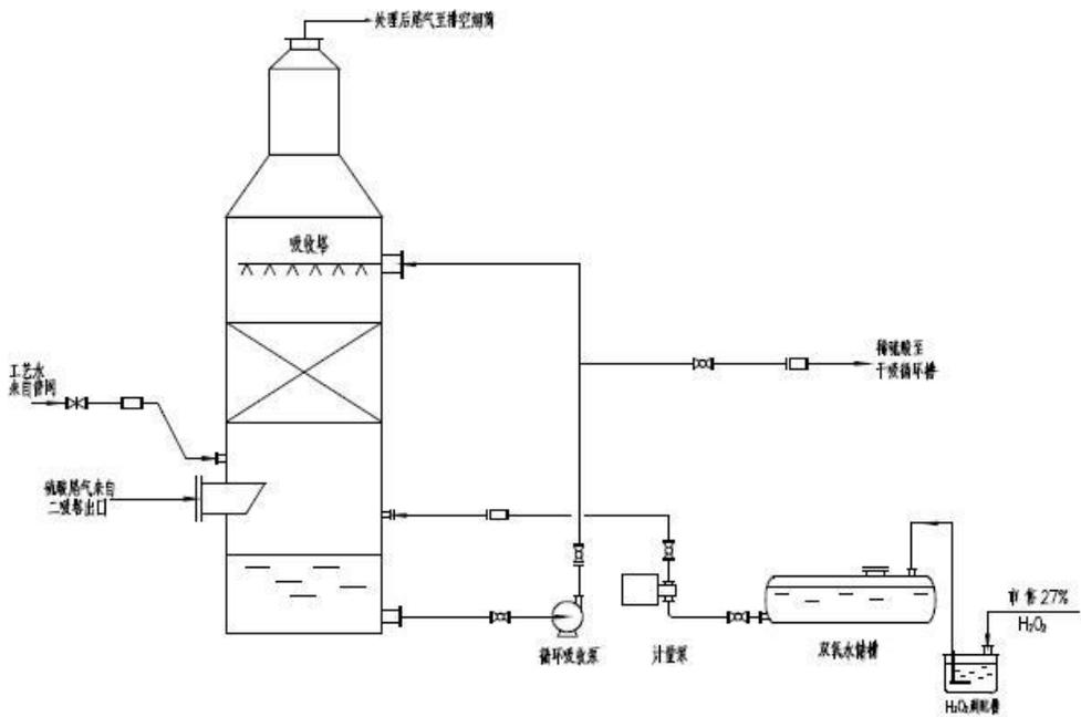
图 8.1-2 双氧水脱硫的工艺流程简图
