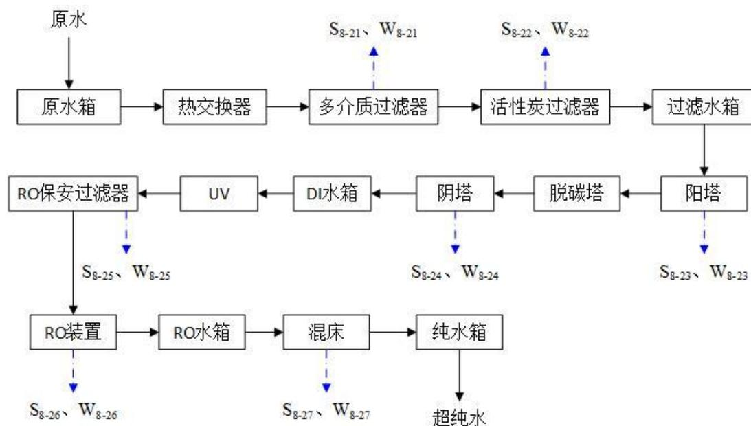
图 4.8-2 超纯水处理站工艺流程及产污节点图
