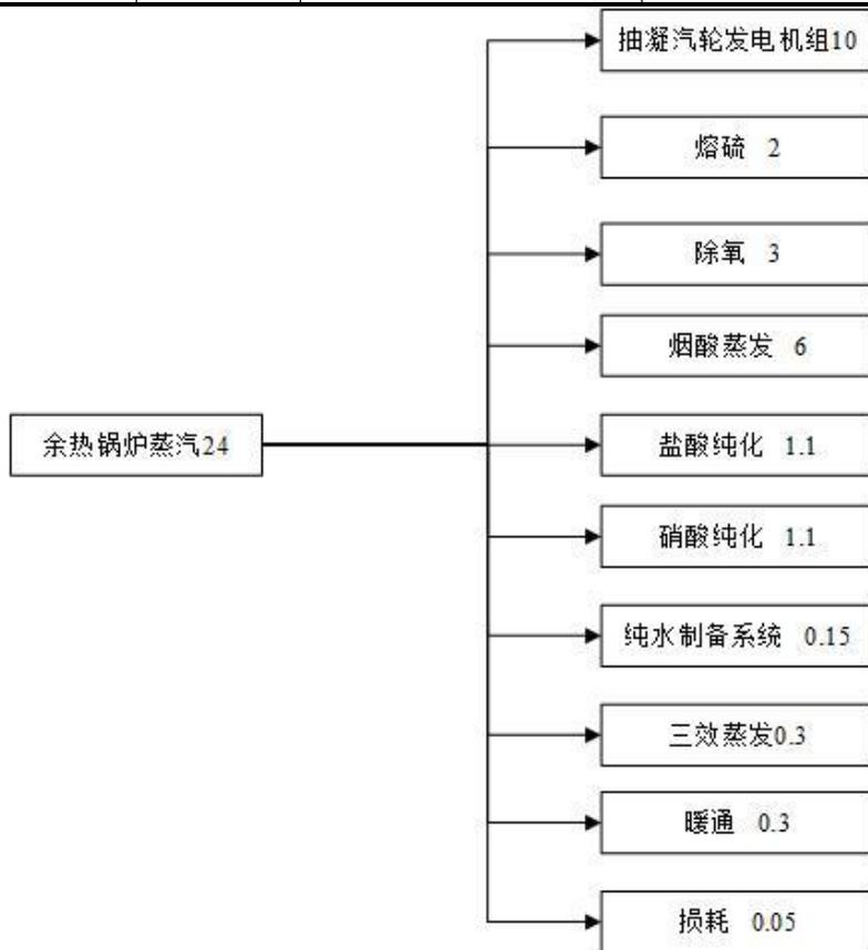
图4.11-1 项目蒸汽平衡图（单位：t/h）
