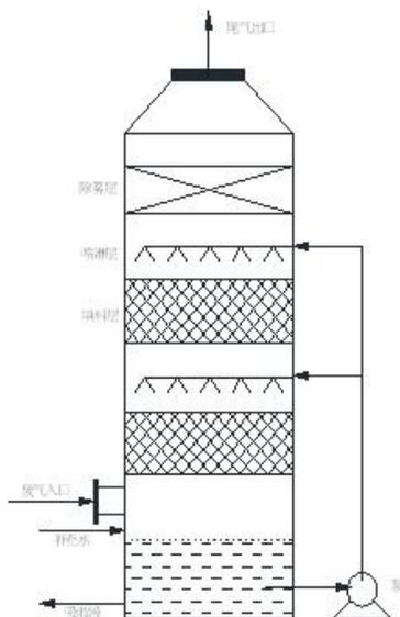
图 8.1-4 喷淋塔吸收工艺示意图
