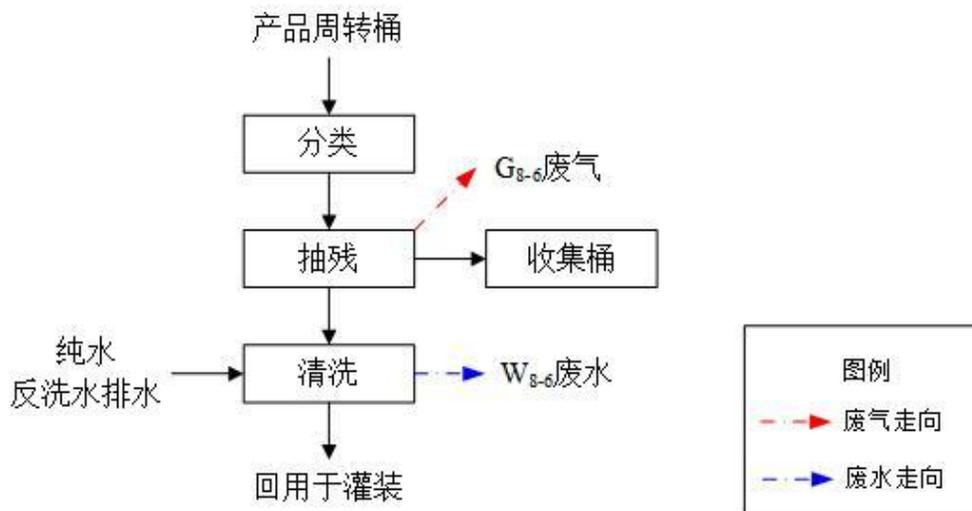
图 4.8-5 洗桶工艺流程及产污节点图
